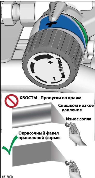
Мелкодисперсный, равномерно распределенный окрасочный факел      Неровности
